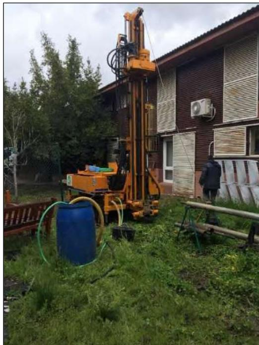
*Fotografía 1. SONDA empleada RL 48 L DE ROLATEC. Fuente: elaboración propia.*
