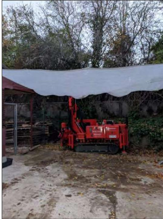
Fotografía 2. SONDA empleada. Sonda CEFRE 2017 DE. Fuente: elaboración propia.
